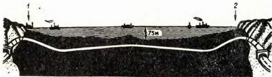
Схема трассы тоннеля под проливом Ла-Манш: 1 — Фолкстон (Великобритания); 2 — Сангат (Франция).
