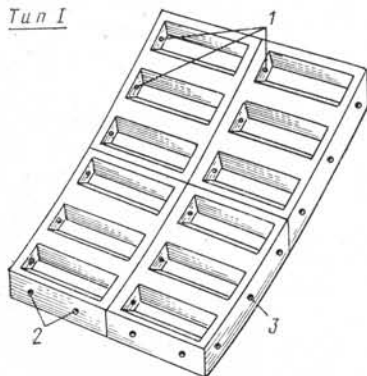
Рис. 1. Схема сейсмостойкой ребристой обделки с болтовыми продольными связями:
