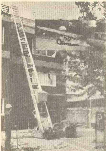
Рис. 5. Подъемник телескопического типа, установленный на шасси (в собранном виде буксируется автомобилем).
