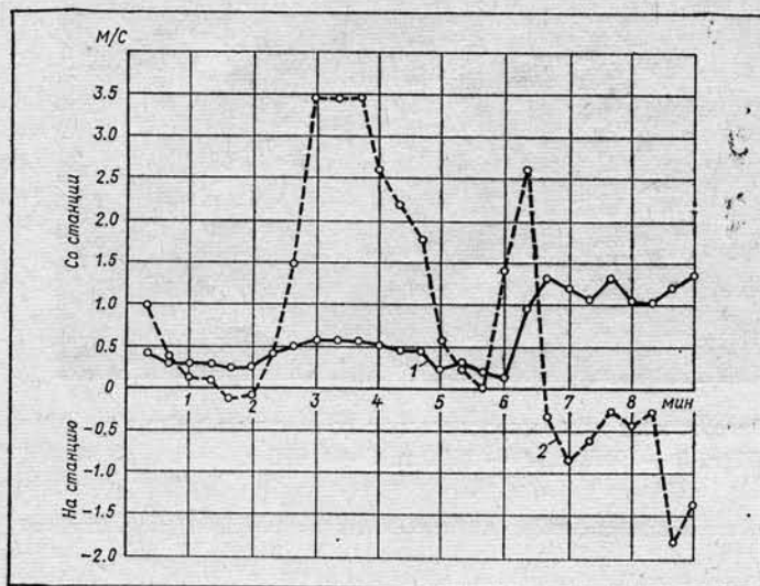
Рис. 1. Подвижности воздуха на станции «Водный стадион» при интенсивности движения поездов 10 пар/ч.
