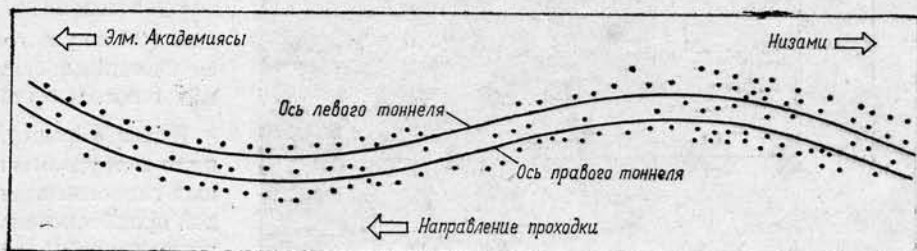
Рис. 1. Схема водопонижающих скважин.
